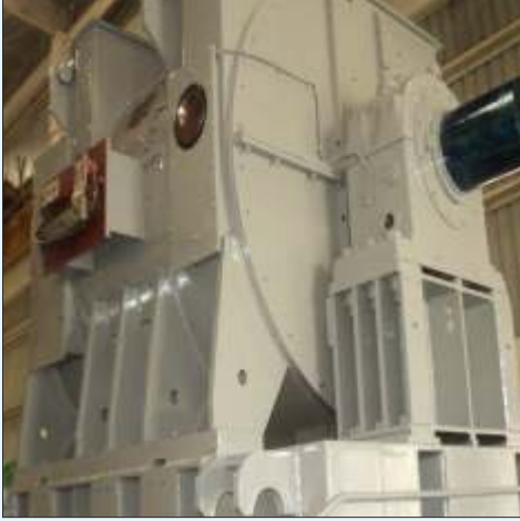
15MW, 11KV, Motor
