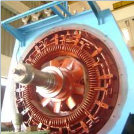
10MW, 11KV, Motor
